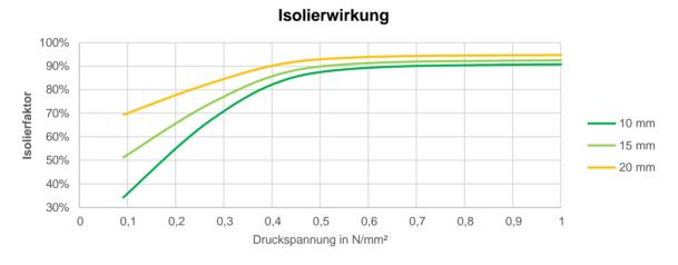
Dargestellt ist die Isolierwirkung von ELR 8 bei einer Erregerfrequenz von 100 Hz.
